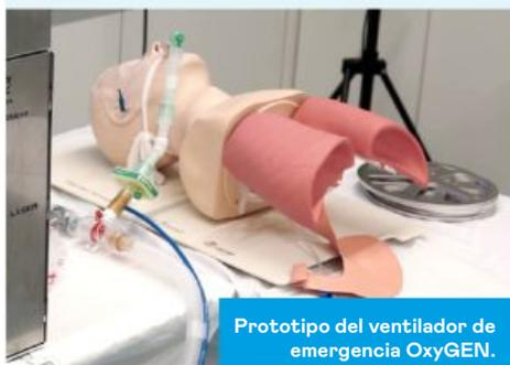
Prototipo del ventilador de emergencia OxyGEN.
